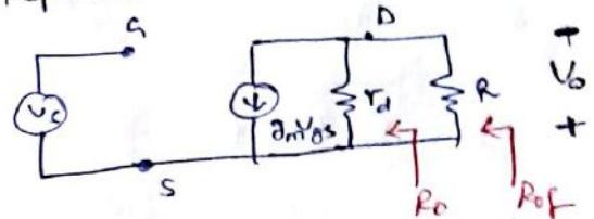
S<sub>4</sub>: Calculate  $A_v$ ,  $\beta$ ,  $A_{vf}$ ,  $R_{if}$ ,  $R_{of}$ .
