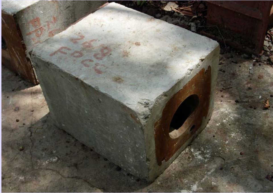
(d) End block after casting
